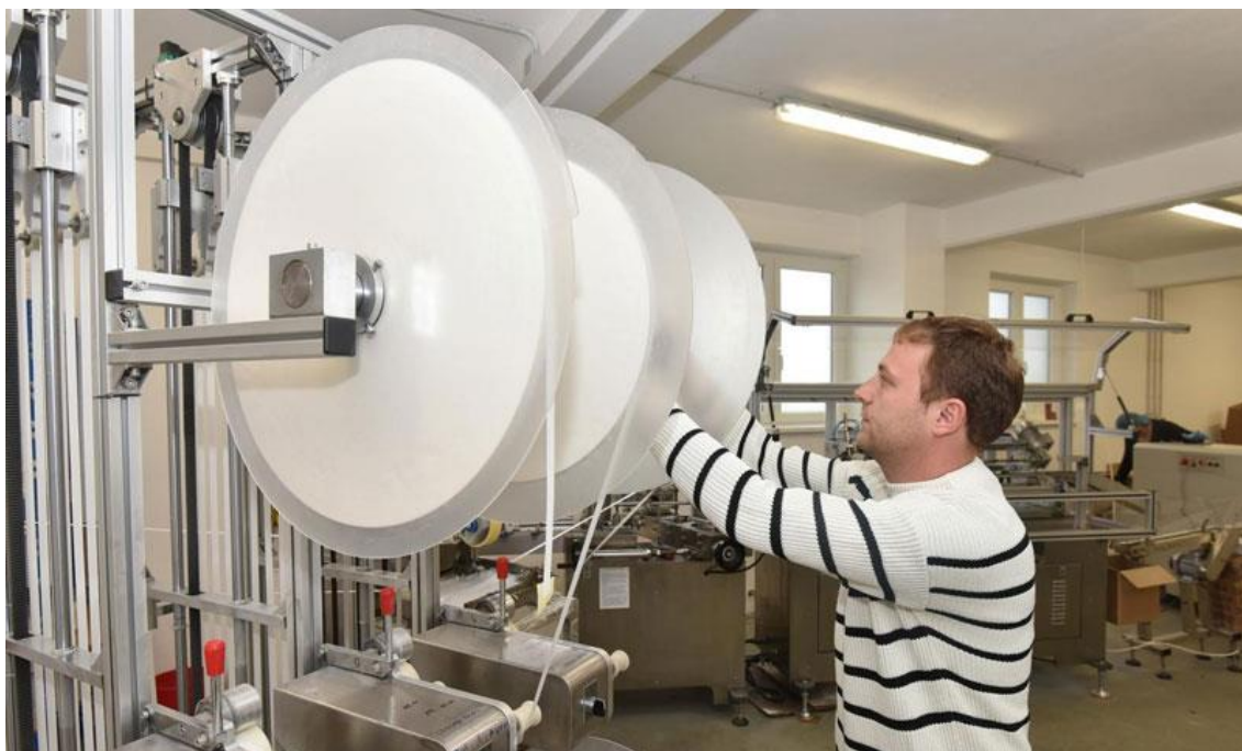
Slika 2. Dio stroja za izradu slamki
